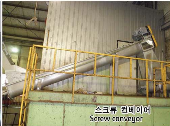
경사식 컨베이어 Incline conveyor
